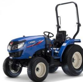
37 PS, transmission hydrostatique et 4x4
