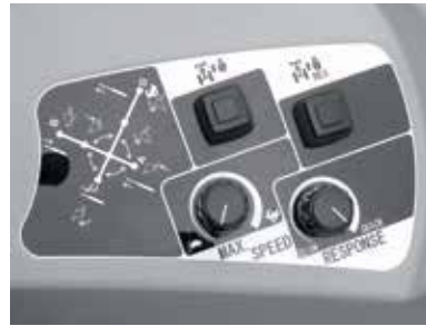
POTENTIOMÈTRES DE RÉGLAGE DU TEMPS DE RÉPONSE DU GROUPE HYDRO ET DE VITESSE D'AVANCEMENT, RÉGULATEUR DE VITESSE ET MÉMORISATION DE VITESSE.
