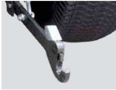
ATTELAGE 3 POINTS À L'ARRIÈRE AVEC CROCHETS D'ARRÊT DE SÉRIE
