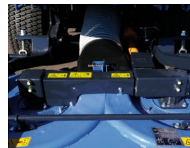
TRANSMISSION AUX LAMES ENTIÈREMENT MÉCANIQUE (PAS DE COURROIE)
