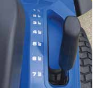
SYSTÈME MÉMOIRE RÉGLAGE DE HAUTEUR DE COUPE (SLE122+, en option sur les autres modèles)
